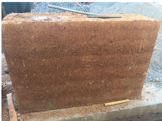
四號實驗牆：100斤新土+60斤機沙+3斤水泥
