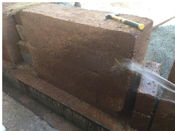
用急水柱沖刷試驗第三號牆
