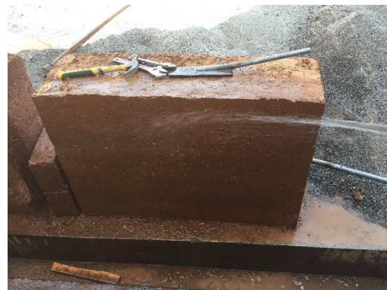
用急水柱沖刷試驗第四號牆
