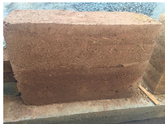
三號實驗牆：100斤老土+140斤機沙+3斤水泥
