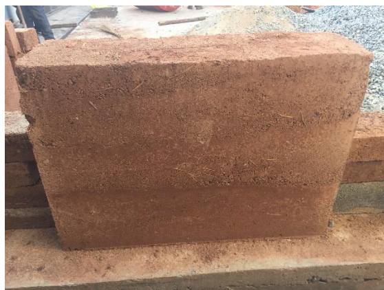
二號實驗牆：100斤老土+120斤機沙+2.5斤水泥
