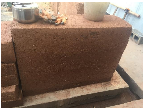
一號實驗牆：100斤老土+100斤機沙+2斤水泥
